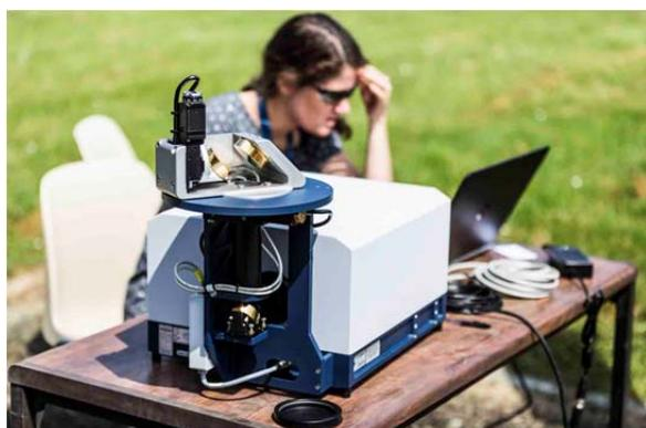
L'EM27 est un spectromètre à transformée de Fourier portable. Il est équipé d'un héliostat piloté par une caméra qui renvoie le rayonnement solaire dans le spectromètre avec une direction constante. La haute résolution (de 0,5 cm<sup>-1</sup>) permet de résoudre les raies des composés minoritaires de l'atmosphère. Le spectromètre enregistre des spectres dans l'infrarouge entre 2,5 et 0,8 micromètre avec deux détecteurs. Un logiciel
