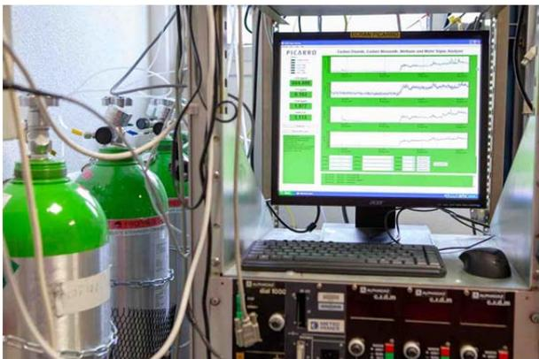
Analyseur d'air atmosphérique Picarro pour la mesure de concentration de CO<sub>2</sub>, CH<sub>4</sub> et CO, volant à bord du Falcon 20 de Safire, ici en calibration en laboratoire © CNES/Nicolas TRONQUART, 2018
