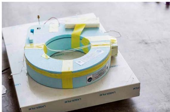
L'AirCore est un échantillonneur atmosphérique développé par le Laboratoire de météorologie dynamique (LMD, CNRS / Ecole polytechnique / ENS Paris / Sorbonne Université)<sup>1</sup>, volant sous ballon météorologique. Il permet la mesure des profils verticaux (de la surface à 30 km d'altitude) de concentration atmosphérique de gaz à effet de serre (CO<sub>2</sub>, CH<sub>4</sub> et CO). Son concept, basé sur une idée proposée par la NOAA américaine, est extrêmement simple : il
