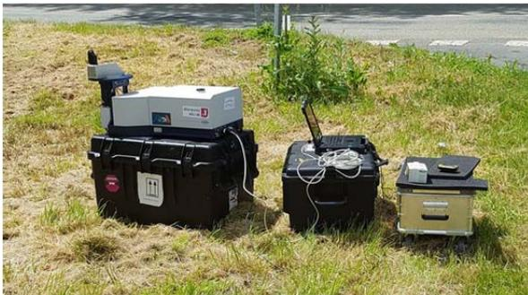
Le spectromètre infrarouge CHRIS est un prototype instrumental développé pour le Laboratoire d'optique atmosphérique (LOA, CNRS/Université de Lille) par la société Bruker. Ses caractéristiques générales (masse, volume) ainsi que son fonctionnement sur batterie, lui permettent d'effectuer des mesures de terrain avec une autonomie d'une douzaine d'heures. Ses caractéristiques
