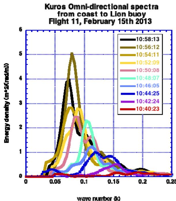
Spectres omnidirectionnels des vagues en fonction du nombre d'onde à partir des observations KuROS acquises le long de l'axe A-B de la figure a ci-dessus.
